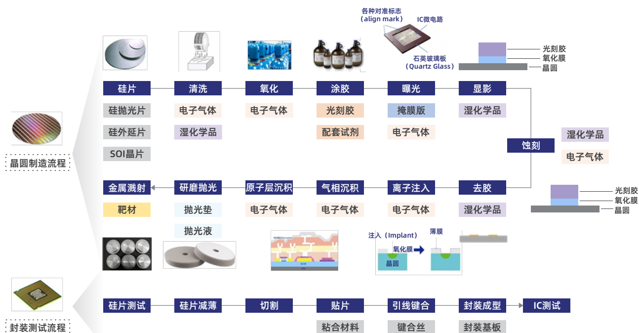
晶圆制造流程和封装测试流程中需要的半导体材料
